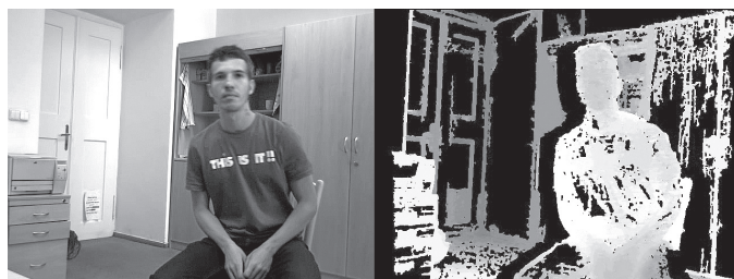
Obr. 2: Obrázek z levé kamery stereosystému a odpovídající pseudobarvná hloubková mapa vypočtená z obou obrazů. V černé oblasti hloubkové mapy není žádné měření, a to buďto pro nedostatek textury (bílá zed) nebo v oblasti zákrytu v pravé kameře (nalevo od kontury osoby).
